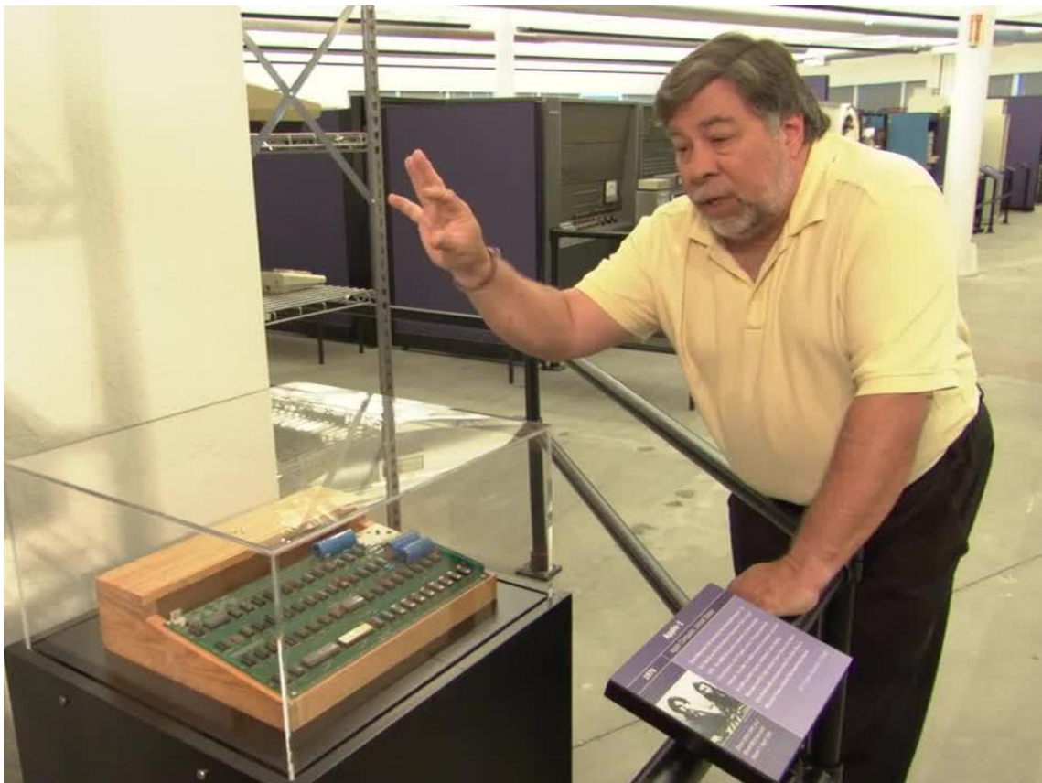
Kép aláírás: Apple I, 1976. Steve Wozniak konstrukcióját már összeszerelt alaplapként árulták. A tápegységről, billentyűzetről és házról azonban a vásárlónak kellett gondoskodnia.
