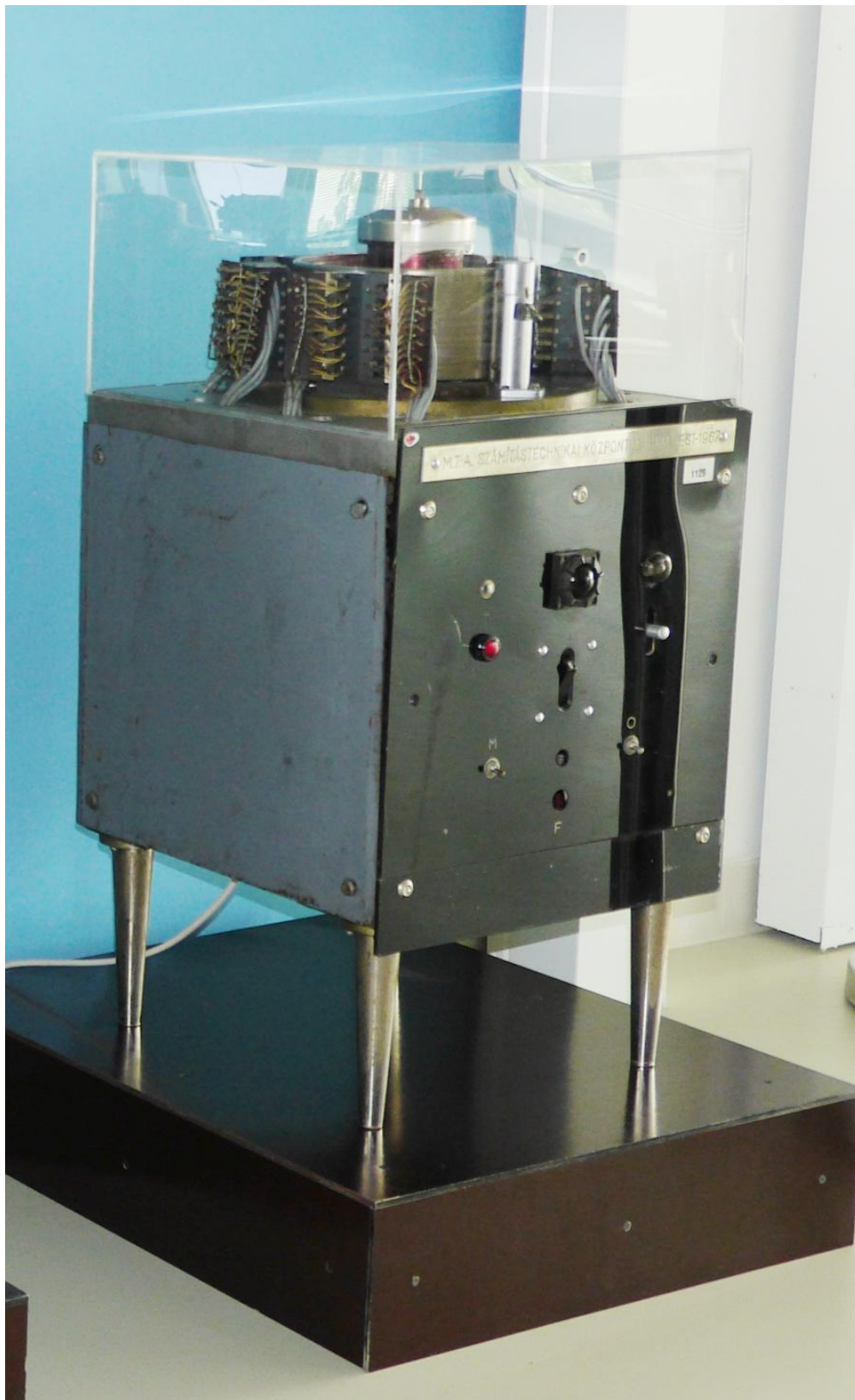
Képalírás: Az M-3 elektronikus számítógép dobmemóriája, Magyarország első működő elektronikus digitális számítógépe. A gép 1959-ben kezdte meg működését az MTA Kibernetikai Kutatócsoportjában.
